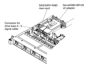
Figure 46. ServeRAID-BR10il v2 adapter cable connection
