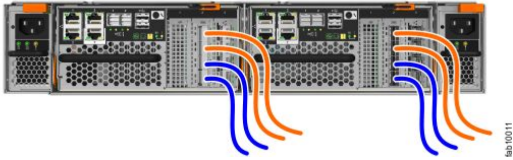
图 26. 每个容器连接四条光纤通道电缆的示例配置
