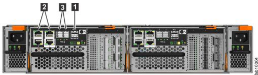
图 2. Lenovo Storage V7000 控制机柜后部的数据端口
